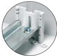
Возможность монтажа устройств различной глубины путем перемещения DIN-рейки в тот или иной паз (47, 54, 64, 74 мм)
