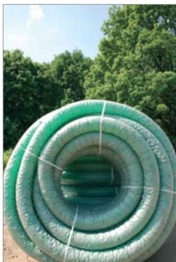
Для облегчения работы дренажные трубы и трубы ливневой канализации прокладывают параллельно в одной траншее и под одним уклоном. При этом верх трубы в самой высокой точке должен быть ниже уровня подошвы фундамента. Ливнесток, как правило, врезается в водопримемный колодец на более высоких отметках и предполагает залповые сбросы в период интенсивного дождя. Чтобы избежать захле-
