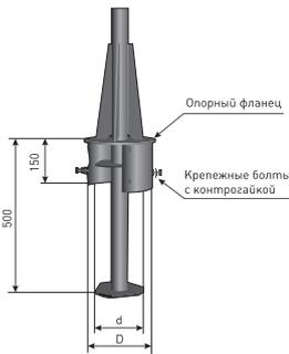
Рисунок Б.1 – Характеристика установочных мест кронштейнов с обечайками (тип «О»)
