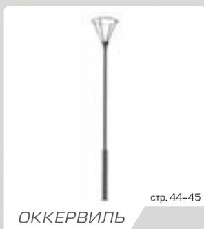
Система отраженного света состоит из опоры, прожектора и отражателя. Обладает высокой вандалоустойчивостью: прожектор, защищенный закаленным стеклом, крепится на самой опоре, либо встраивается в ее верхнюю часть. Световой поток направляется вверх на отражатель и распределяется по всей его поверхности. Это дает эффект ровного, комфортного освещения, не дающего бликов на поверхностях.
