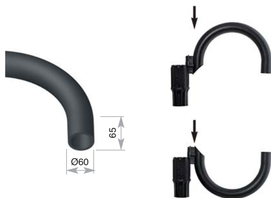
способ монтажа консолей Р в головке
