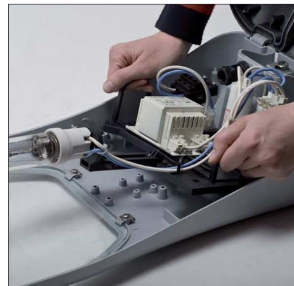
Способ демонтажа электрической оснастки
