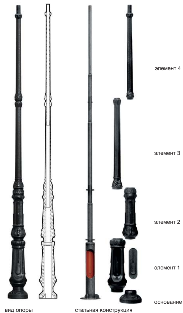
Пример строения опоры S-40 W
