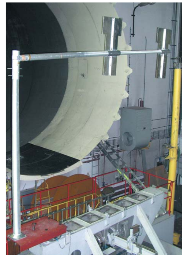
Испытание выдержанности опоры для навешивания дорожных сигнализаций
